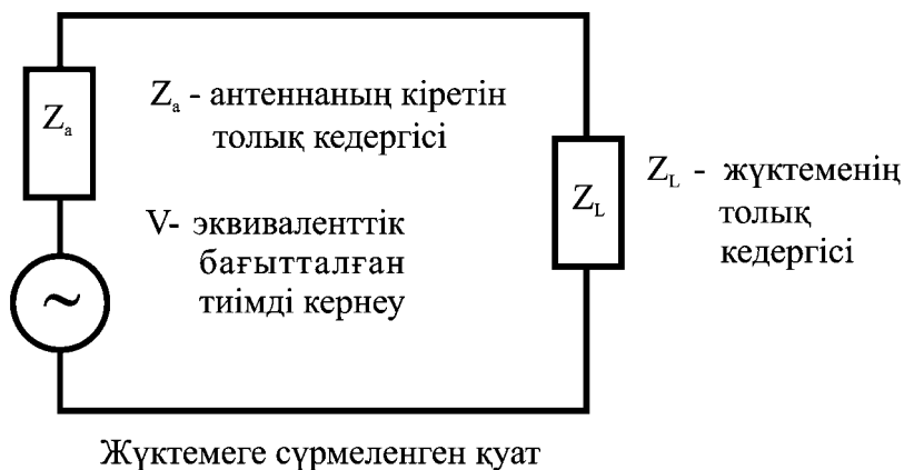
36-сурет. Антеннаның эквиваленттік сұлбасы
